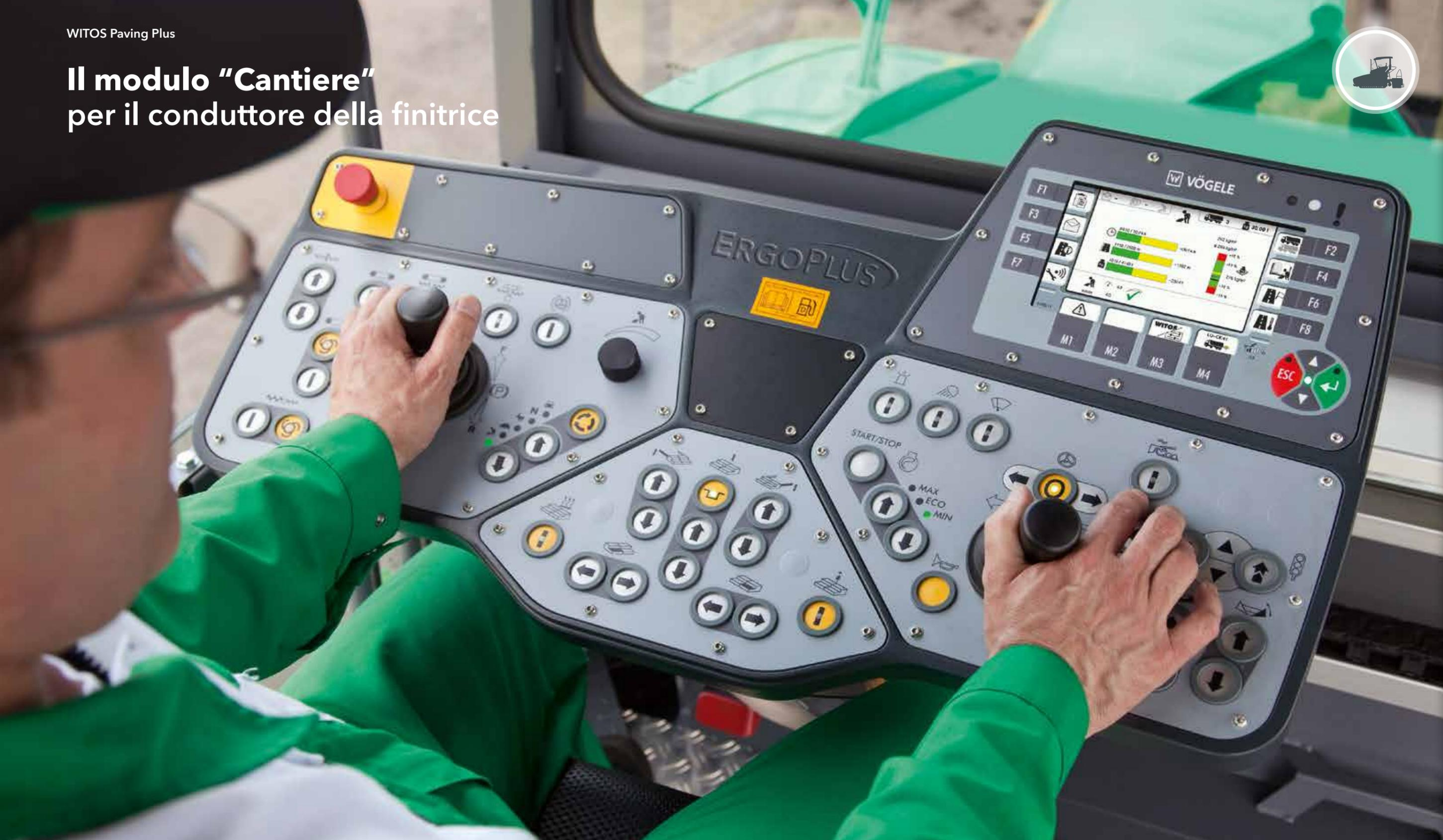
Il modulo "Cantiere" è parte integrante del sistema di comando VÖGELE ErgoPlus 3 e offre al conduttore della finitrice un sistema unico nel suo genere per il controllo e l'ottimizzazione del processo.
