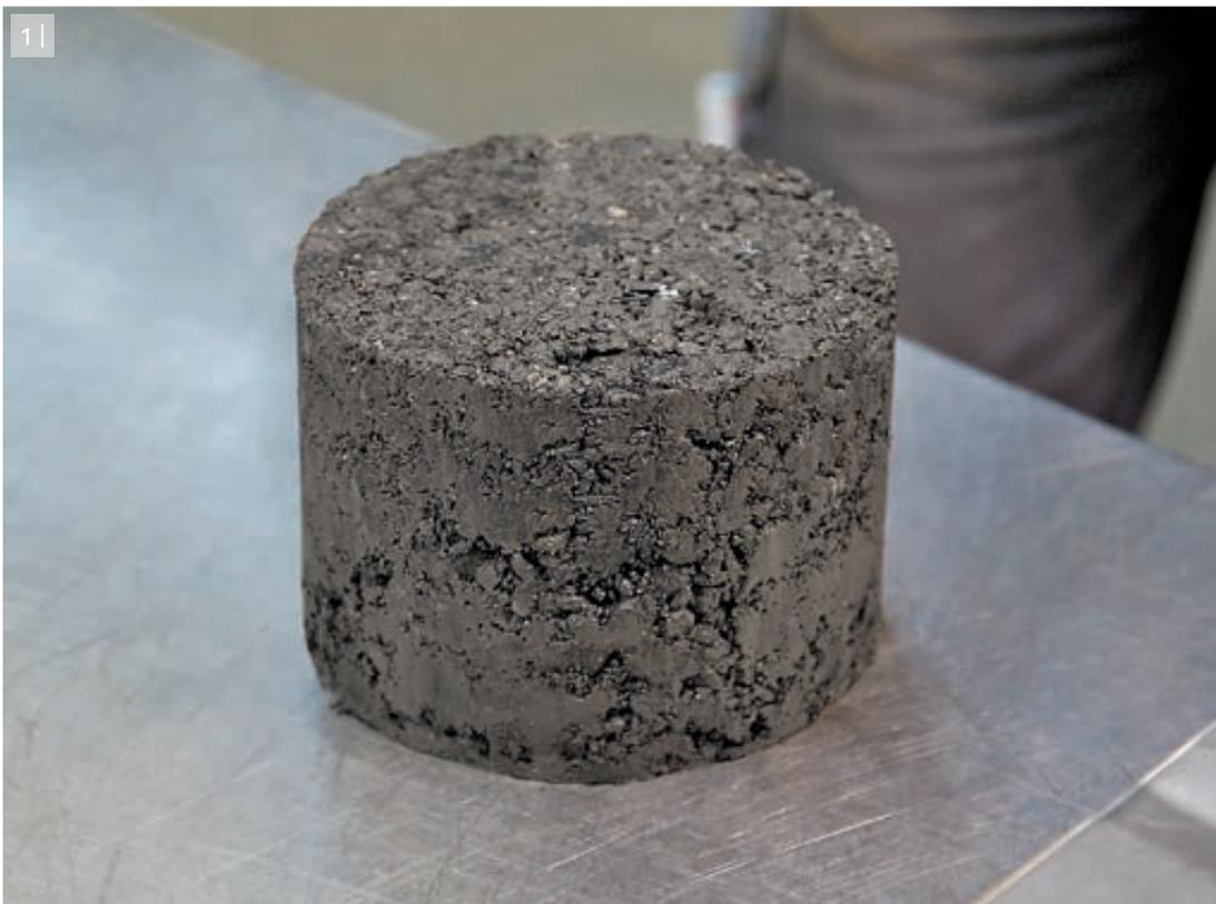
1 | Mit Schaumbitumen behandeltes Material zeichnet sich durch optimale Festigkeit und Tragfähigkeit aus.
