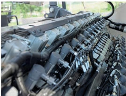
2 | *... die exakte Zugabe über die gesamte Arbeitsbreite abhängig von Maschinenvorschub und Recyclingtiefe.*
