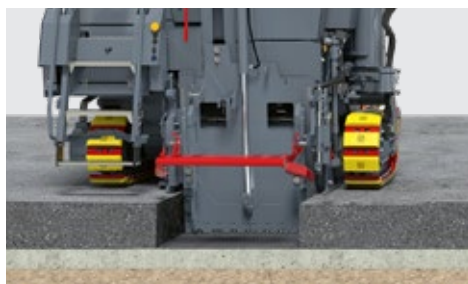
W 100 Fi con gruppo di fresatura da 1,0 m
