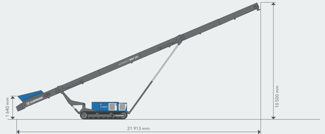
Les convoyeurs de terrils mobiles MOBIBELT sont employés pour le transfert de produit au sein d'un train d'installations ainsi que pour le remblayage de grands terrils. Le transport direct de matériaux de l'installation de broyage ou de criblage vers le terril prévu permet d'éviter des déplacements supplémentaires de
