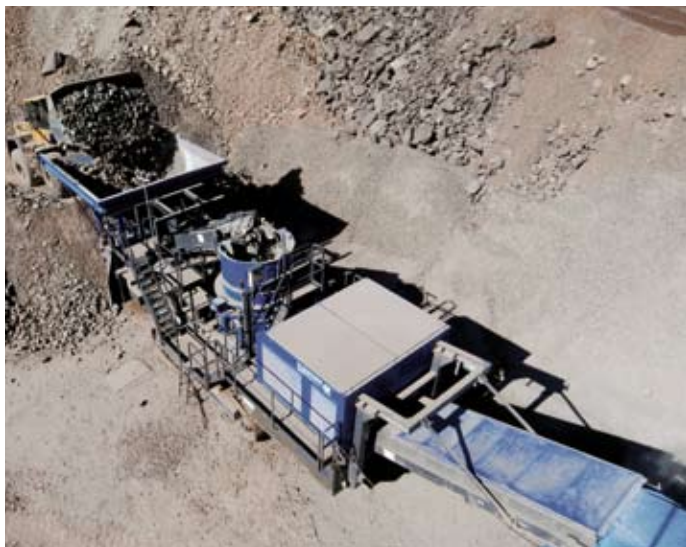
MCO 11 może być także zasilana przy pomocy ładowarki kołowej.
