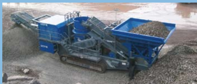
Bardzo istotnym z punktu widzenia technologii elementem maszyny MCO 11 jest jej wielki lej wyspowy.
