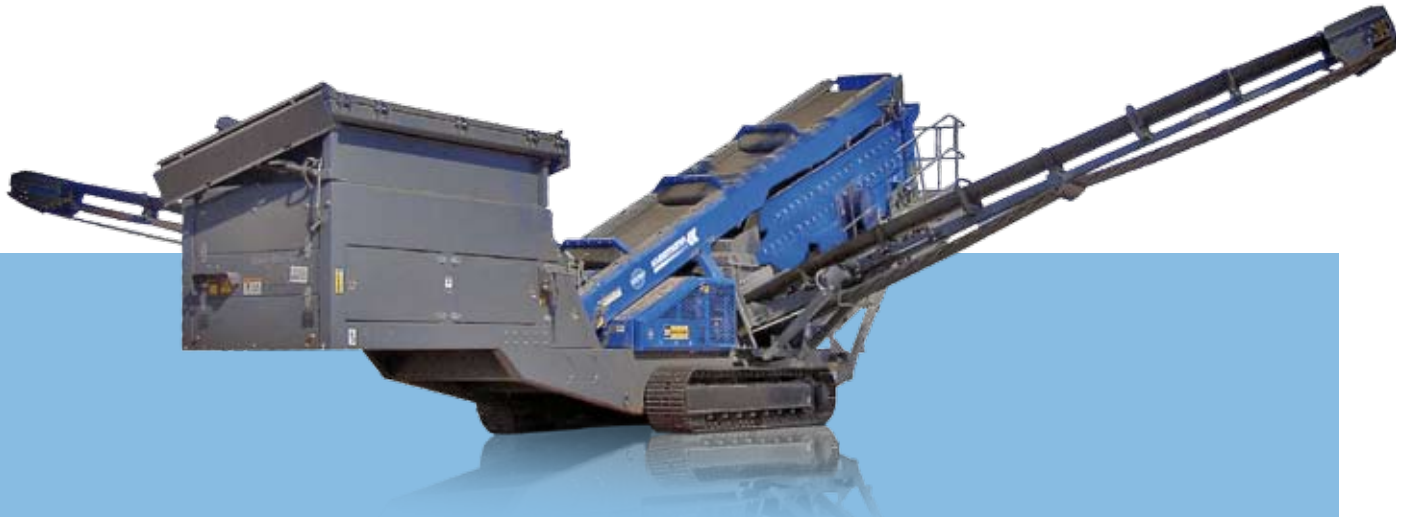
Vista laterale MS 19 D posizione di trasporto
