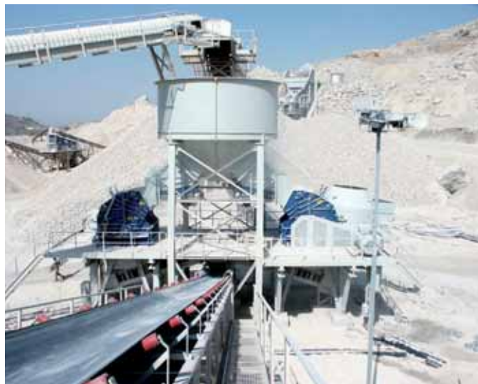
Две роторные дробилки SNH 16, используемые для вторичного дробления
