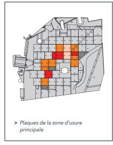
Afin de protéger le bâti du broyeur, celui-ci est entièrement recouvert de plaques d'usure. L'usure varie fortement selon les différentes parties du bâti. Afin de réduire les temps d'arrêt pour le remplacement et économiser des frais liés à l'usure, KLEEMANN propose des plaques avec une couche spéciale soudée.
