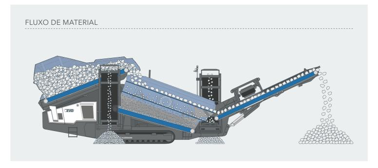
Com seu trem de rodagem de controle proporcional, a planta de peneiramento de fragmentos grosseiros pode ser deslocada com rapidez e precisão, seja do caminhão de plataforma baixa até ao local de colocação ou dentro da obra. A dobragem das correias de descarga lateral pode ser feita sem necessidade montagem ou desmontagem de componentes e permite, assim, uma redução dos tempos de preparação. Uma parede traseira da tremonha
