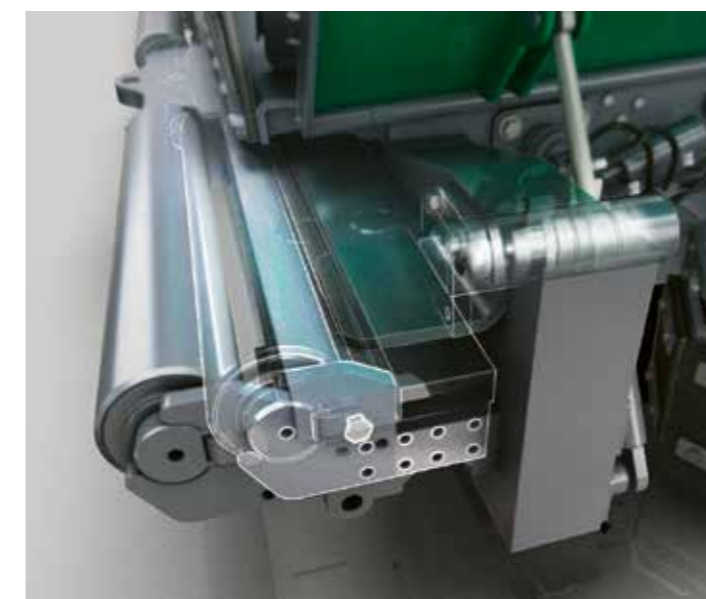
Подрессоренные упорные ролики PaveDock надежно амортизируют все удары самосвалов.
