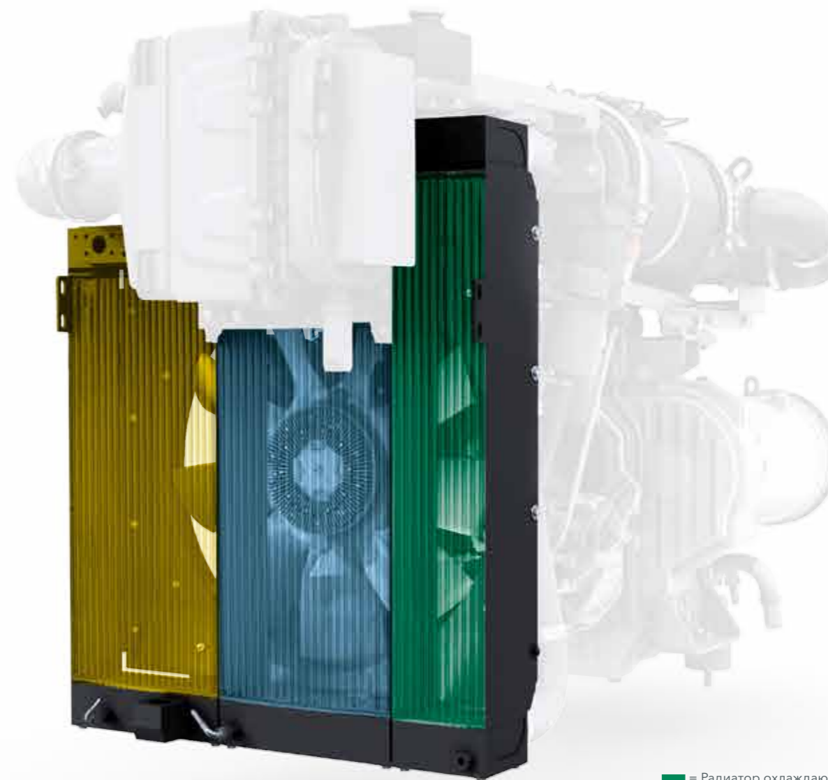
■ = Радиатор охлаждающей жидкости ■ = Радиатор наддувочного воздуха ■ = Радиатор рабочей жидкости гидросистемы
