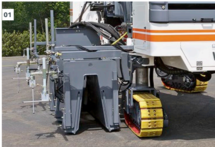
01 - 02 Hydraulisch teleskopierbare Offset-Gleitschalung.
