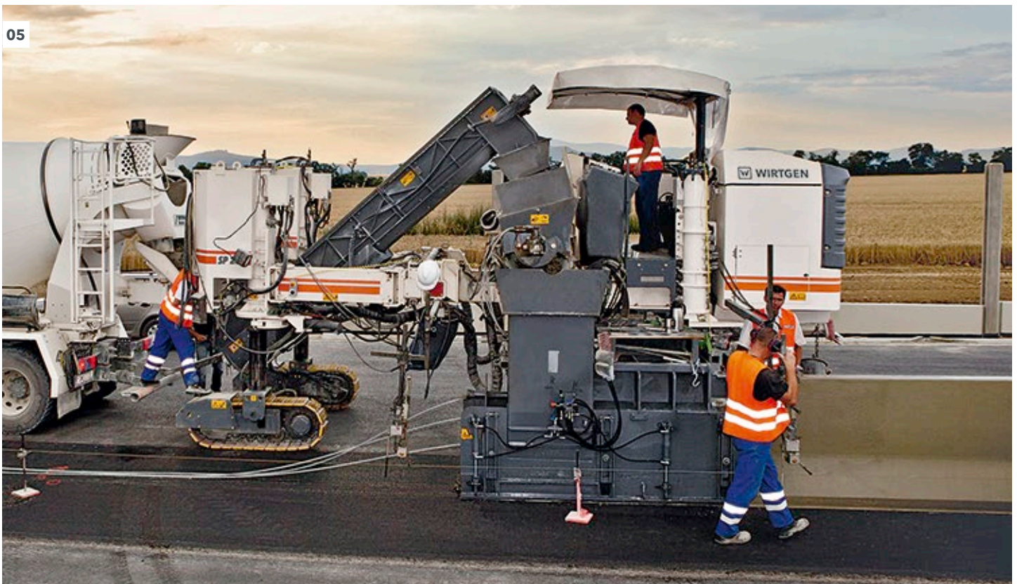
04 - 05 Die Gleitschalung ist wahlweise rechts oder links montierbar – der Umbau erfolgt binnen kürzester Zeit.
