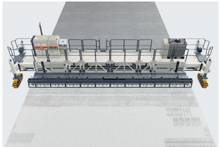
A escovação e a pulverização longitudinais ampliam o espectro para criar diferentes estruturas de superfície.
