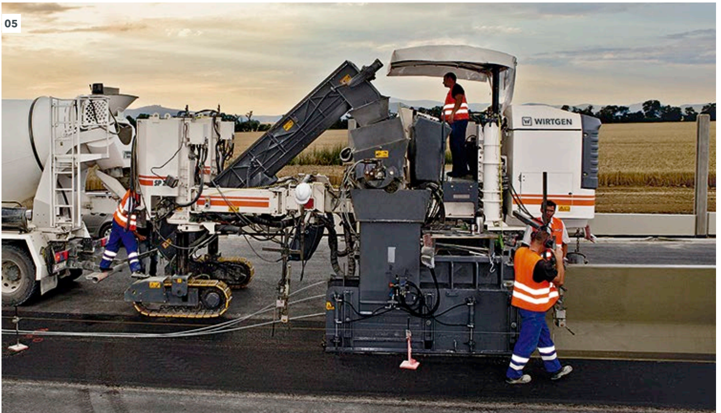
04 - 05 模具能安装在机器的左右任一側 — 仅需很短的时间，便能轻松完成机器改型。
