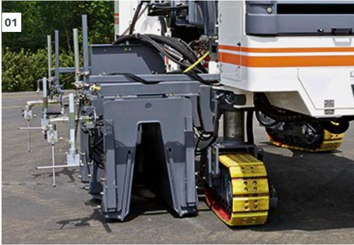
01 - 02 液压伸缩式模具安装支架。
