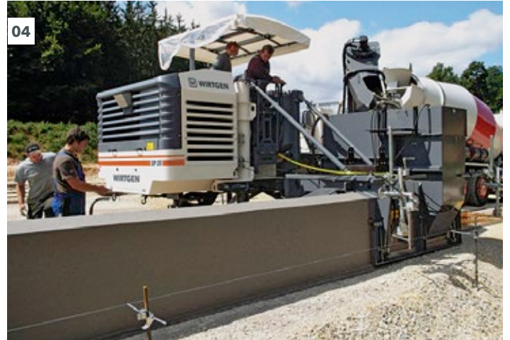
04 - 05 模具能安装在机器的左右任一側 — 仅需很短的时间，便能轻松完成机器改型。
