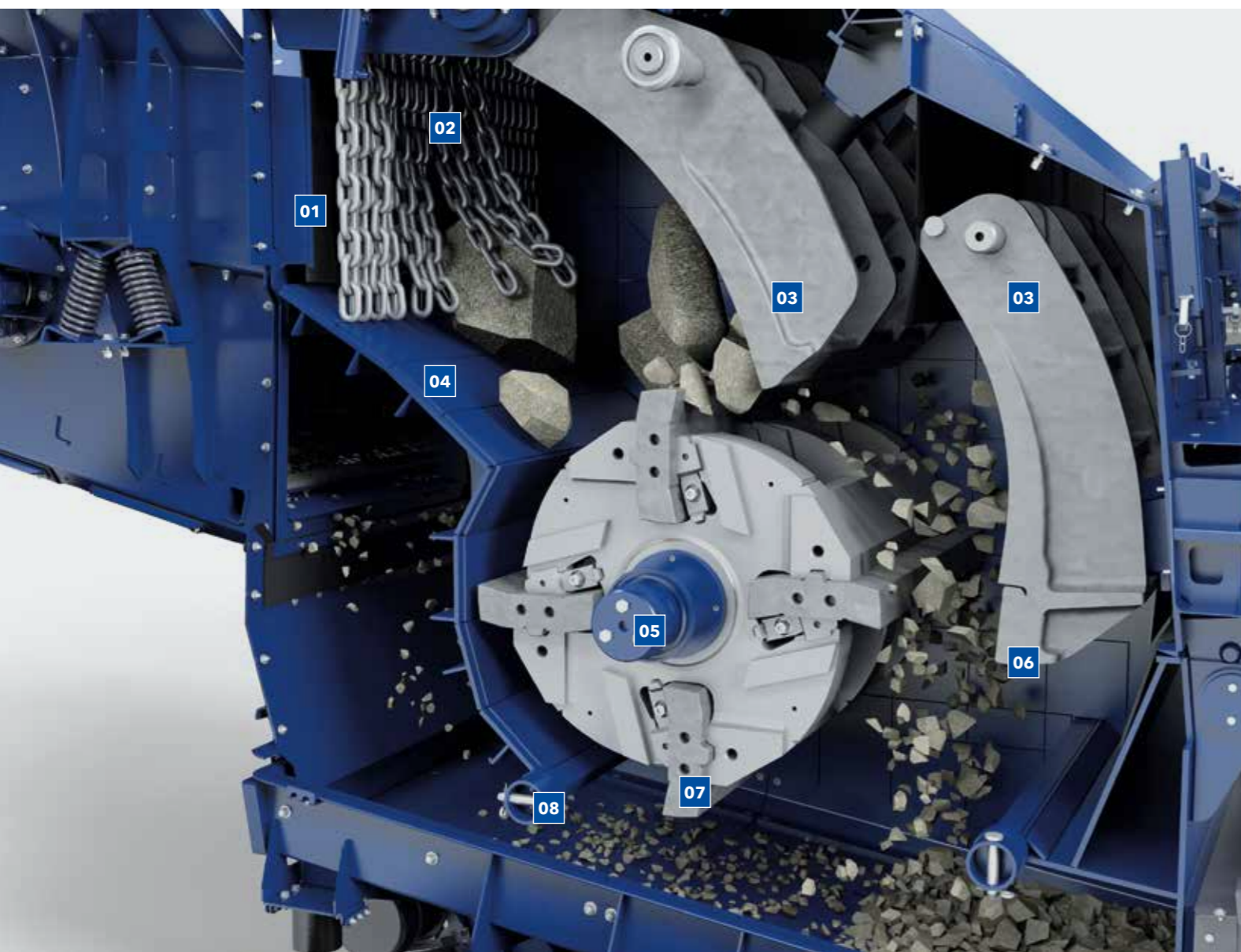
Поверхность листов для внутреннего пространства дробилки. Трещины являются необходимым условием для оптимальной твёрдости.
