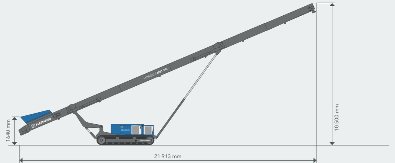
Las cintas de vaciadero móviles MOBIBELT se utilizan para la transferencia de productos dentro de una cadenas de instalaciones y para el vertido de un grandes vaciaderos. El transporte directo de material desde la instalación de machaqueo o cribado hasta el vaciadero previsto evita movimientos del material adicionales con
