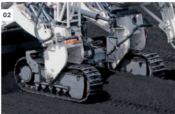
02-03 Alle vier Kettenlaufwerke sind einzeln über Hydraulikzylinder höhenverstellbar.
