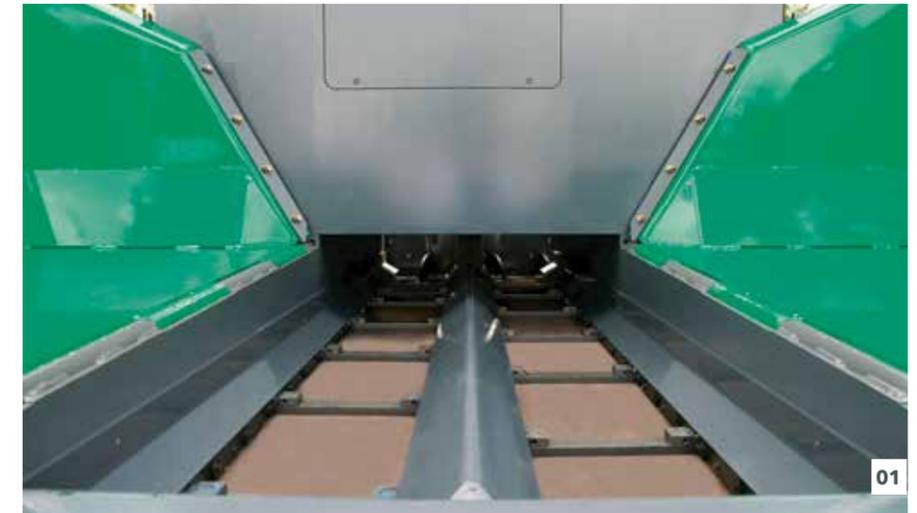
Der Weitertransport des Materials und die gleichmäßige Verteilung vor der Bohle sind dank des großen Materialtunnels, der proportional regelbaren Kratzerbänder sowie der leistungsstarken Verteilerschnecken optimal.
