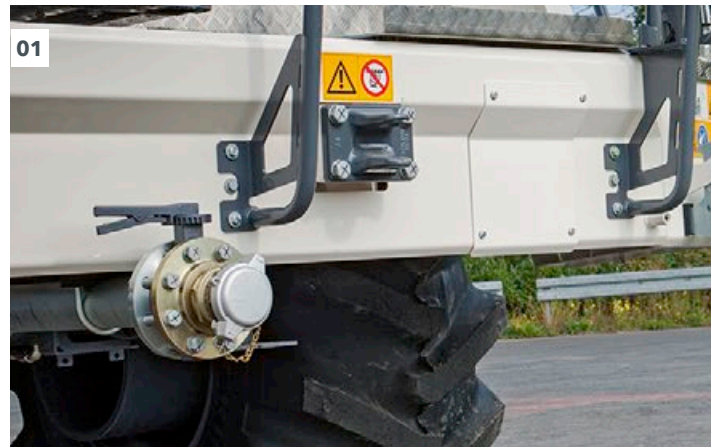
01 Der Schlauchanschluss ist an der vorderen Traverse angebracht.
