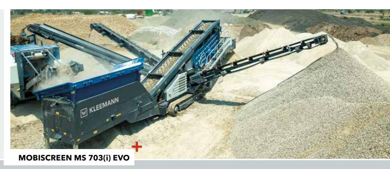
A instalação de crivagem móvel MOBISCREEN MS 703(i) EVO, como crivo de triagem de plataforma tripla, está equipada com uma caixa do crivo de 7 m². Boas medidas de transporte e curtos tempos de montagem distinguem a instalação. O manuseio faz-se através de um sistema de controle moderno. Desta forma, todas as funções são controláveis e os estados operacionais e funções da máquina estão sempre visíveis.
